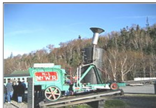
Caldaia verticale sulla ferrovia a cremagliera Mount Washington, New Hampshire (USA) Vertikala kaldrono sur la dentrela fervojo Mount Washington, New Hampshire (USA)
