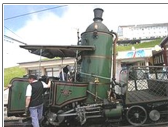
Caldaia verticale sulla ferrovia a cremagliera Vitznau-Rigi (Svizzera) Vertikala kaldrono sur la dentrela fervojo Vitznau-Rigi (Svisio)
