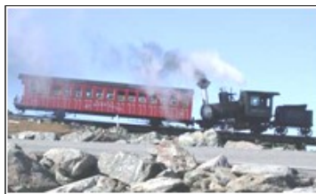
Caldaia verticale, ferrovia a cremagliera Mount Washington (USA) Kaldrono vertikala, dentrela fervojo Mount Washington (USA)
