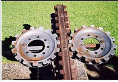
Il sistema Locher della ferrovia del Pilatus La Locher-sistemo sur la Pilatus-fervojo
