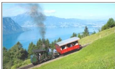
Caldaia verticale sulla ferrovia a cremagliera Vitznau-Rigi (Svizzera) Vertikala kaldrono sur la dentrela fervojo Vitznau-Rigi (Svisio)
