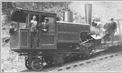
Una locomotiva a vapore a cremagliera che mostra il livello inclinato della caldaia su un tratto in pendenza Denterela-vaporlokomotivo kiu montras la kliniĝan nivelon de la kaldrono sur dekliva vojpeco
