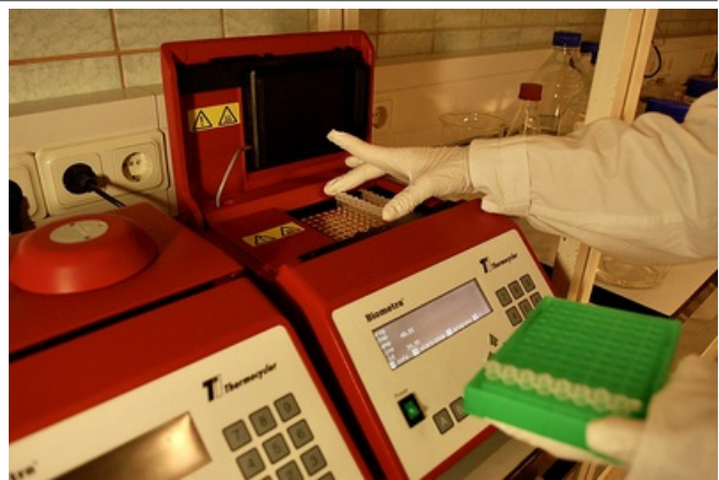
Aparato, kiu cikle ŝanĝas la temperaturon por fari PĈR
