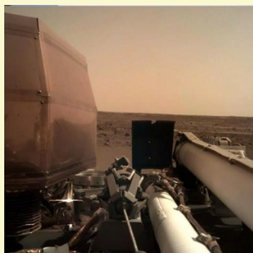
La unua "Memfoto" de InSight. Videblas interalie la robota brako en la mezo de la bildo.
