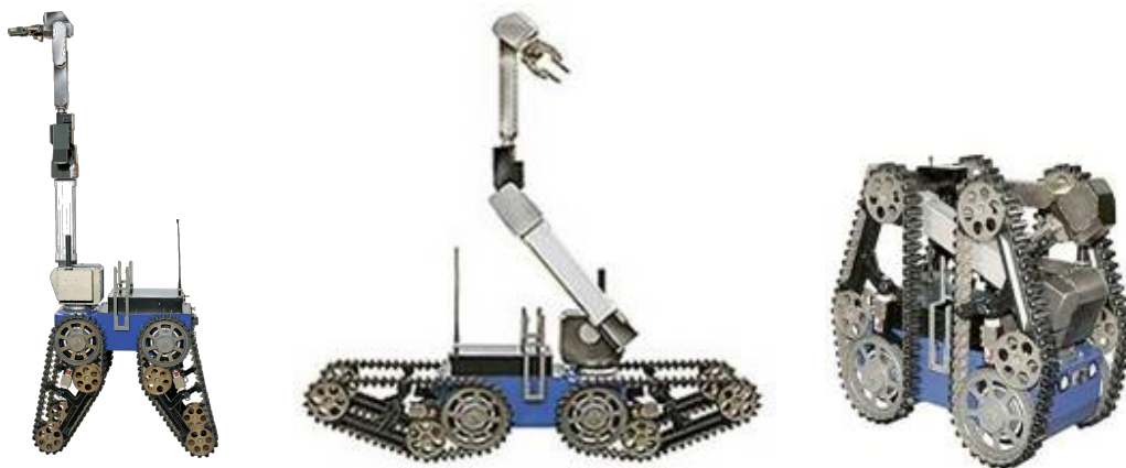
Bildo n-ro 7: La facila piroteknikista roboto TELEMATX en stara, rapidira kaj transporta moduso 18
