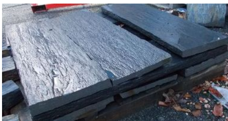
Fig 14: Ardezo-platoj 4cm dikaj konsistigos estetikan rezulton.
