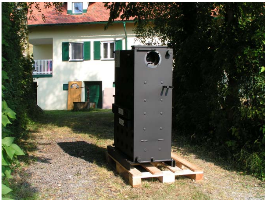
Bildo 3 La forno de Fröling, ekstere de la domo, ankoraŭ sen izolaĵo.
