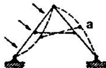
Fig. 9. Transversa truso de libera vertobalka sistemo, vertobalkoj estas ŝoveblaj
