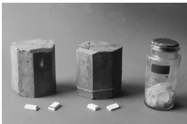
Figuro 5: Korkaj modeloj preparitaj de Pasteur por plifaciligi la studon de la enantiomeraĵoj de racemaj tartratoj. En la realaj kristaloj de amonia natria tartrato (dekstre sur la foto) estas pli malfacile rimarki la “spegulaĵajn surfacojn” [foto el la arĥivoj de la Instituto Pasteur]
