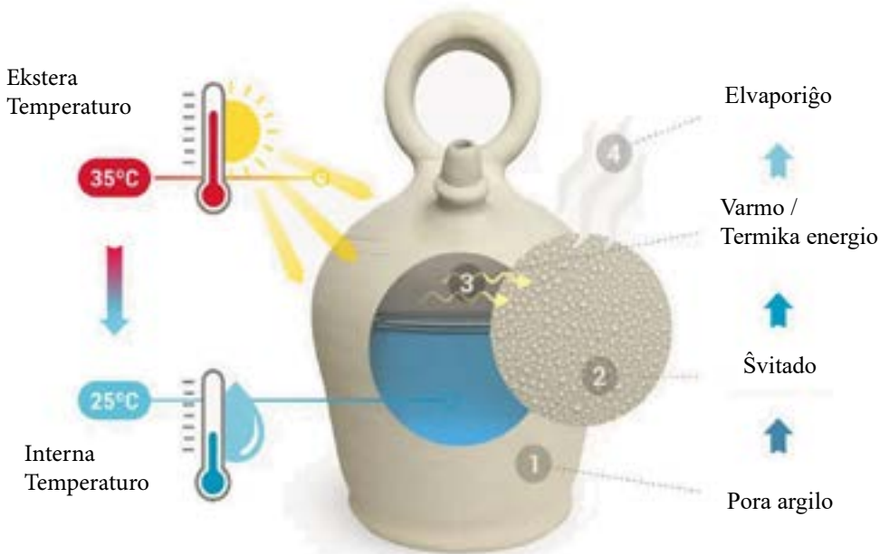
Principo de funkciado de botiĥo
