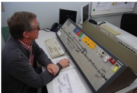
En fervojfunkcia laboratorio Darmstadt la stacio Potsdorf estas kontrolata helpe de relajsa reĝejo tipo DrS2.
