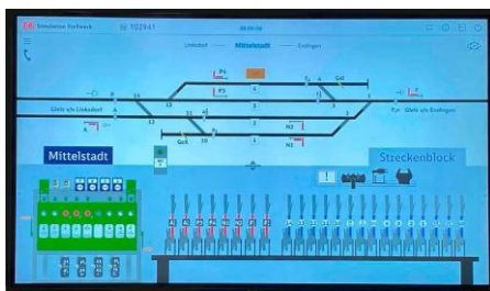
PRESIM-tuŝekrano montras trakplanon kaj mekanikan regejon.
