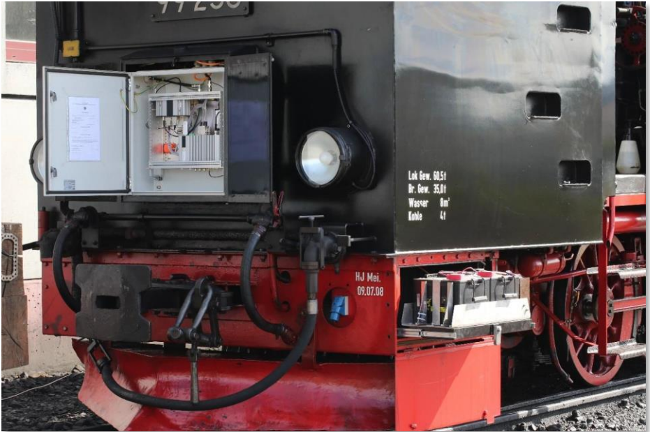
La elektroniko de TrainCAS estas lokita en ŝtala dorsosako. La energio el la dekstre videbla akumulatoro sufiĉas por sep tagoj. Die Elektronik von TrainCas ist in einem stählernen Rucksack untergebracht. Die Energie aus der rechts sichtbaren Batterie reicht für sieben Tage.
