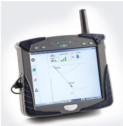
Transportebla TrainCAS-aparato por ekipi fremdajn veturilojn. Tragbarer TrainCAS-Apparat zur Ausrüstung fremder Fahrzeuge. (Foto: loW)
