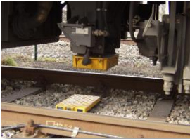
Trakanteno „balizo“ kaj trakiila anteno Balise mit Fahrzeugantenne (bildo/Bild: www.siemens.com/presse )
