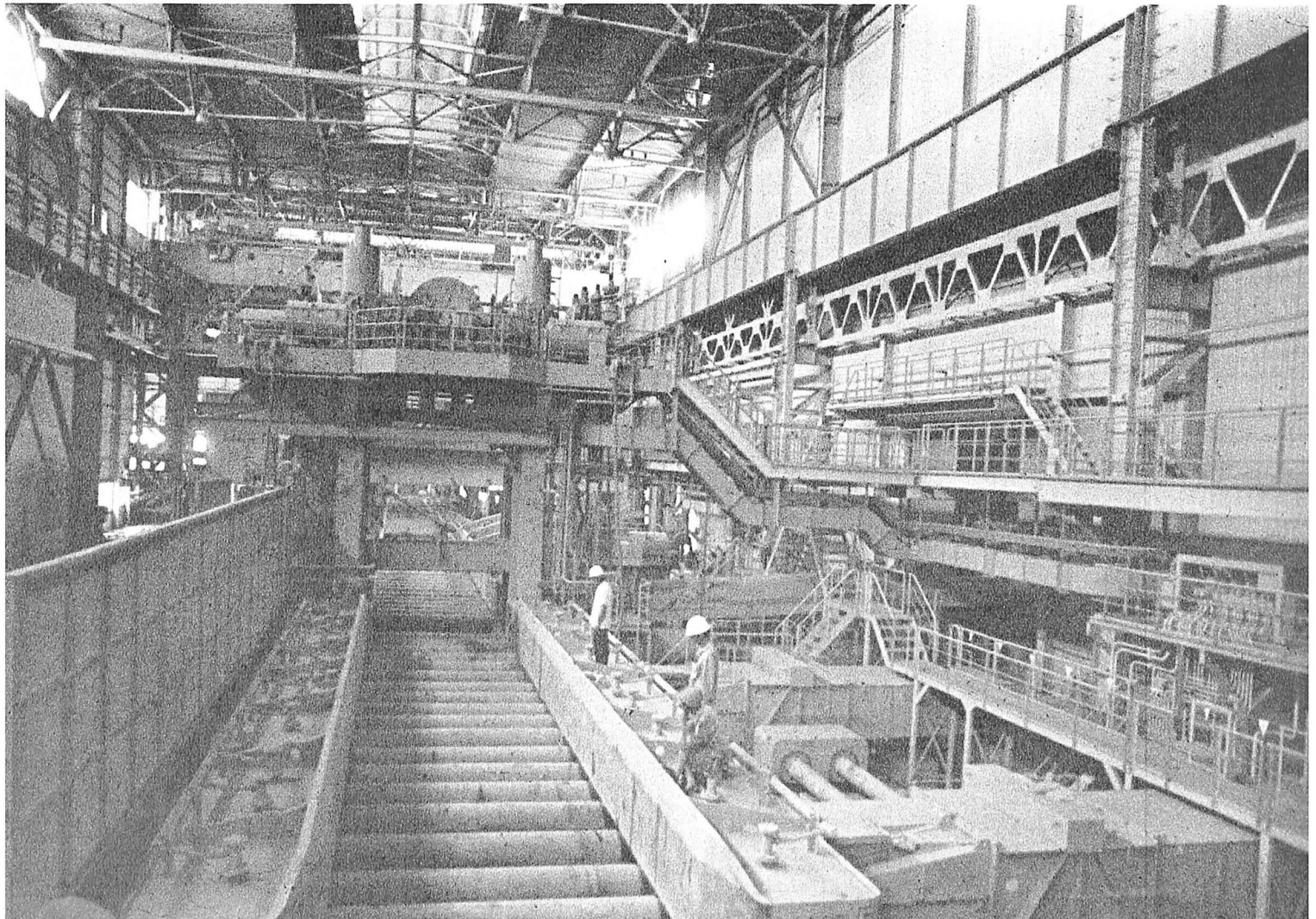
Laminejo kun laminatilo 1 300 mm en manipula provado
