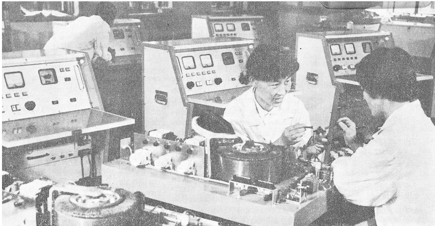
La Dandong-a Mezurila kaj Instrumenta Fabriko de Liaoning-provinco produktis plurspecajn perfektajn mezurajn instrumentojn. La foto montras, ke laboristinoj alĝustigas 400-kilovoltan X-radian fendo-detektilon por industria uzo.
