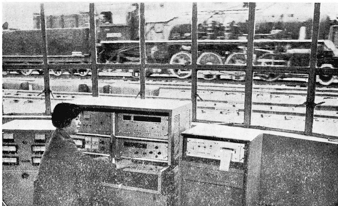
Elektronika traka pesilo por vagono en movado, farita de la Wuhan-a Pesila Fabriko
