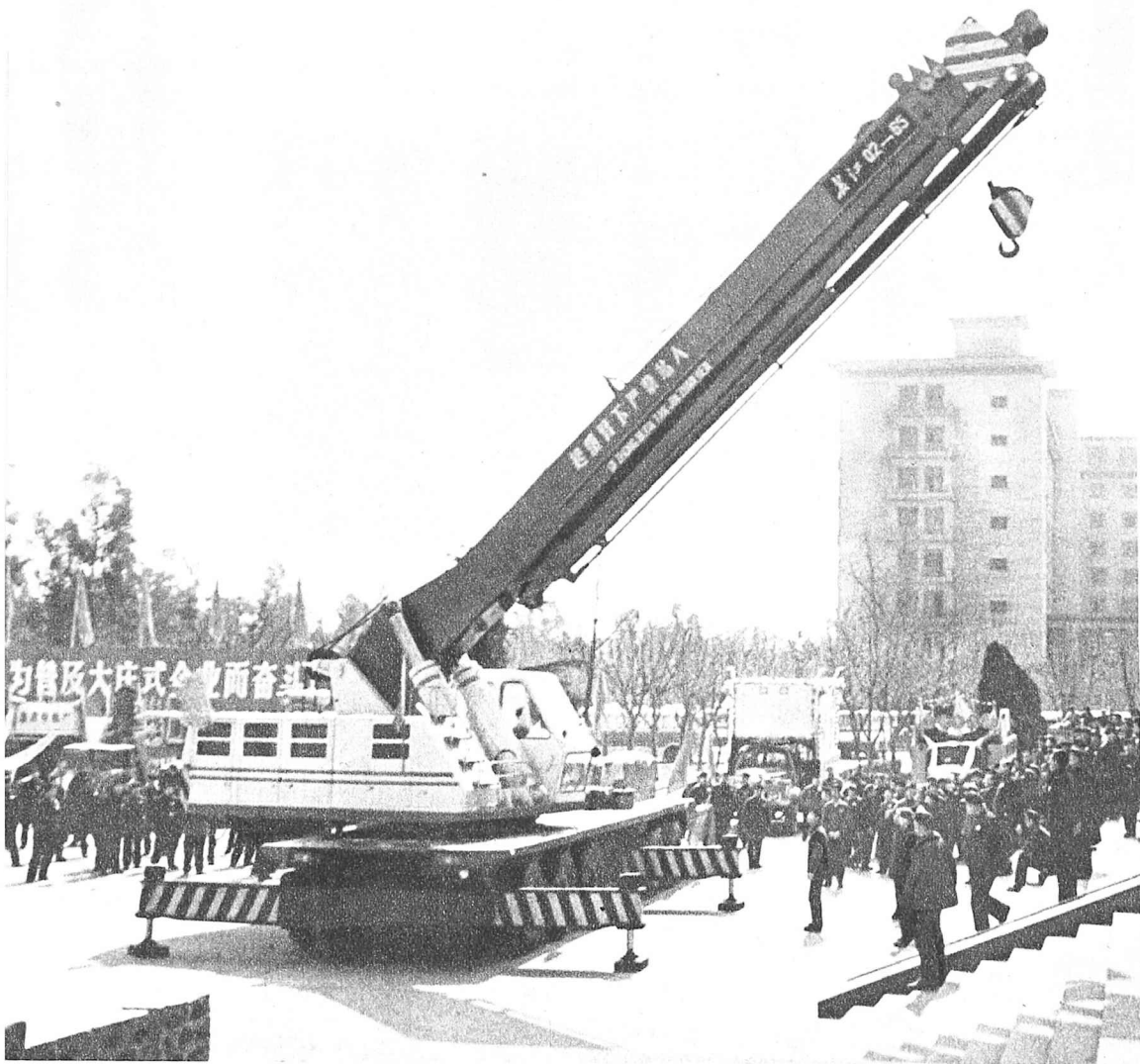
65-tuna hidraŭlika pezleva aŭto farita de la Pezlevila Fabriko Ĉanggiang de Siĉuan-provinco
