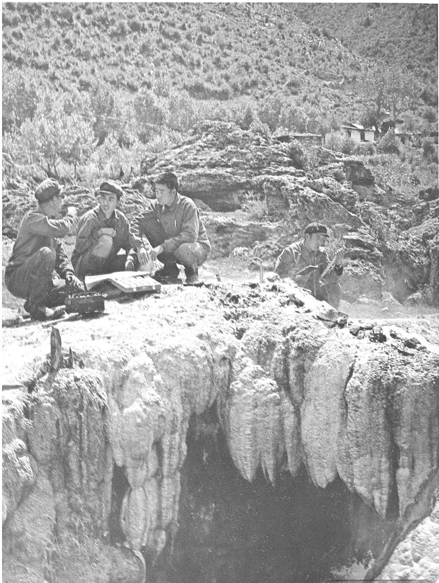
Kolekto de gasospecimeno de geotermika fonto
