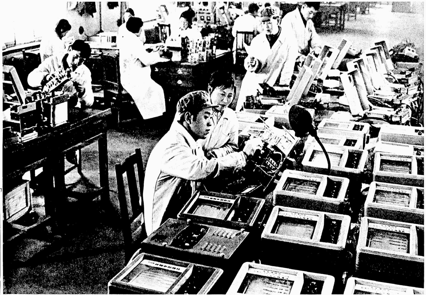
Ljuda konstruis sian elektronan industrion. Jen laboristoj de la Dalian-a Fabriko de Elektronaj Instrumentoj muntas detektilojn de fiŝaro.
