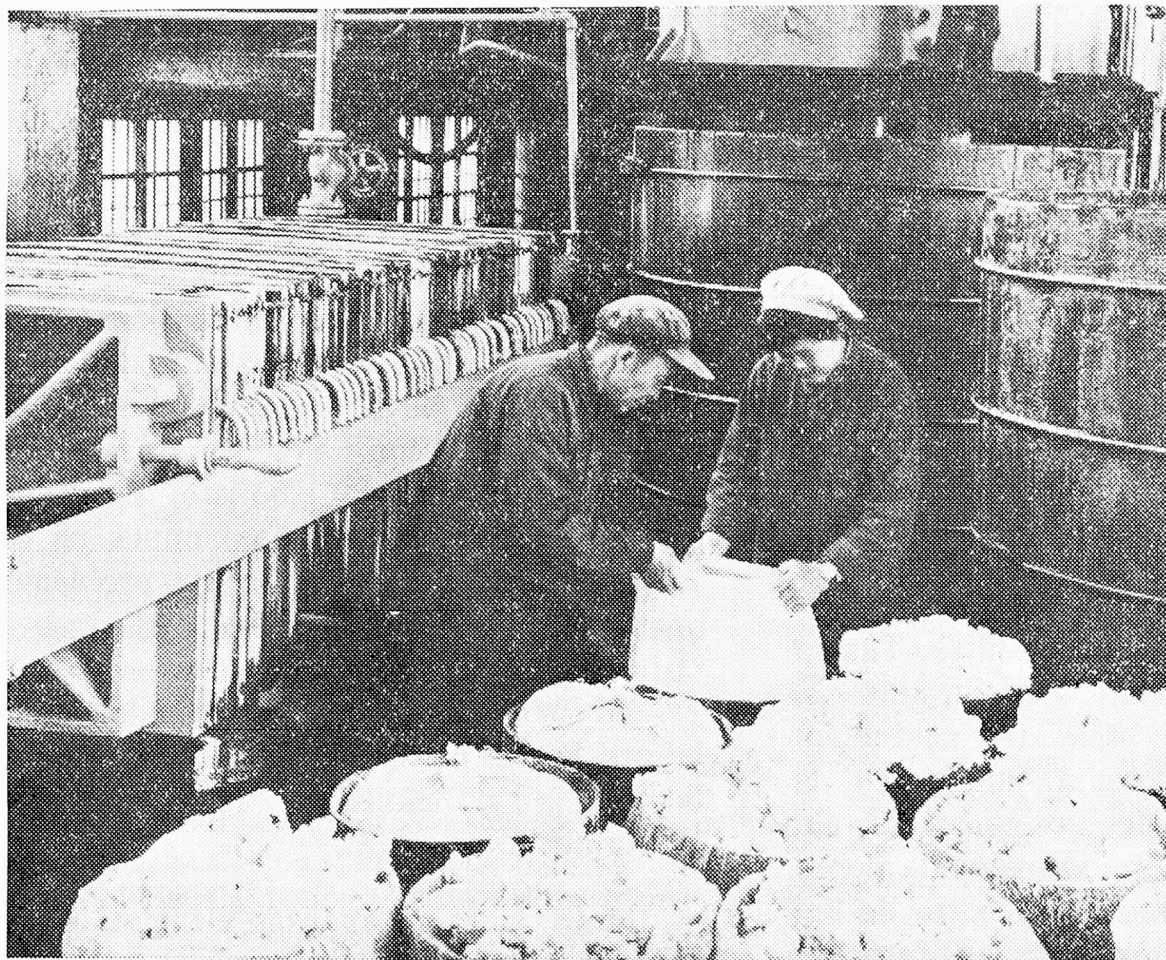
La artrezina laborejo de la Presinka Fabriko de Ŝanhajo reprenis aluminian hidroksidon el eluzita likvaĵo.
