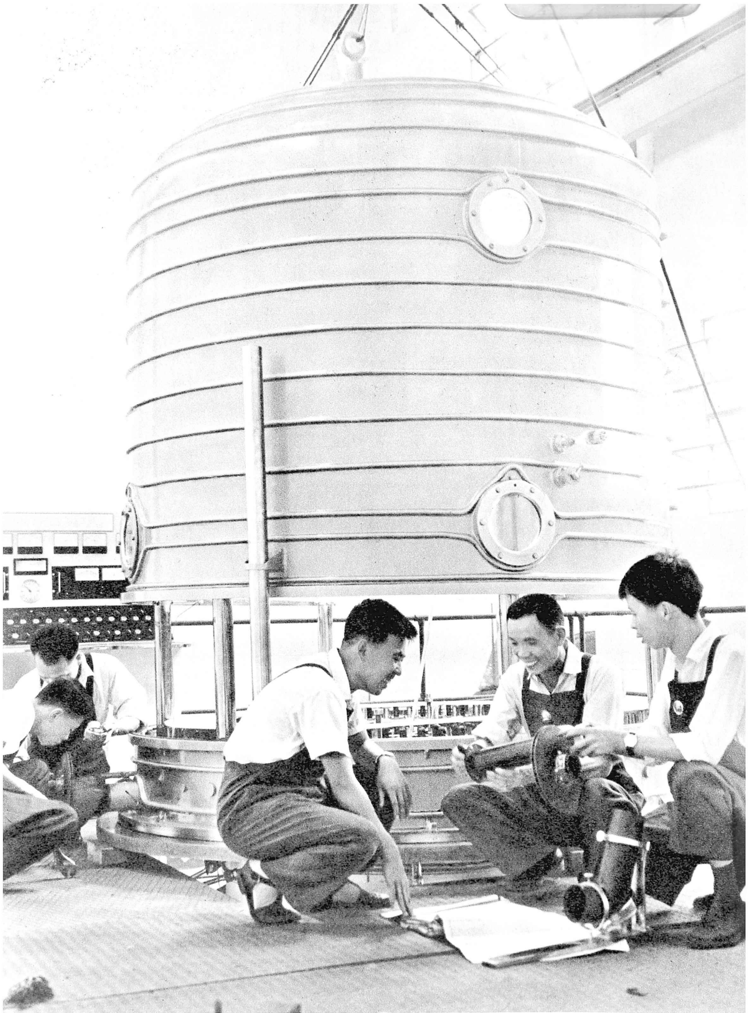
Helpate de sciencesploraj unuoj, la Ŝanhaja Maŝin-fabriko "Aŭroro" sukcese provfabrikis grandan altvakuan multtavolan kovrigilon.
