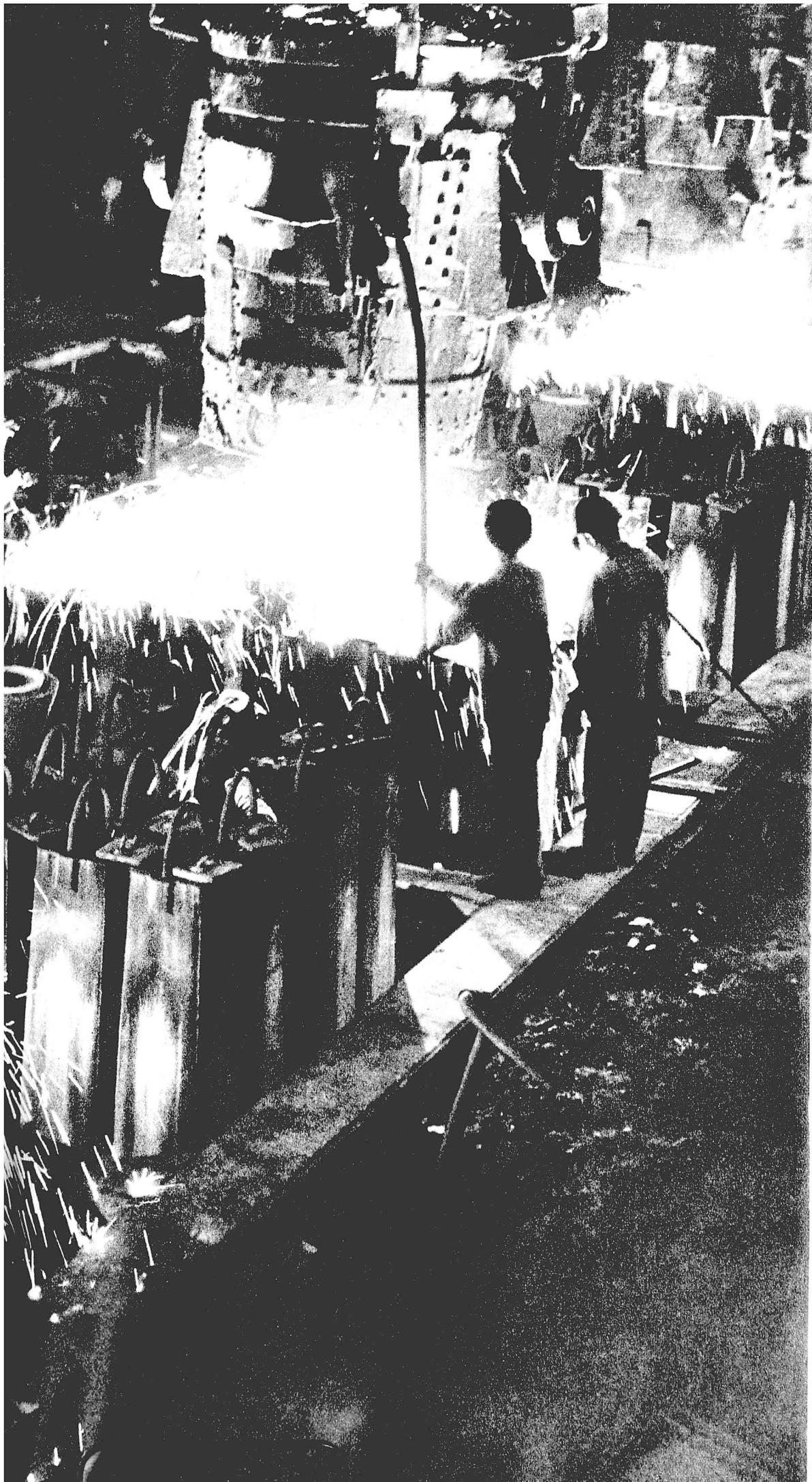
La ŝanhaja metalurgia fronto nun ĉiujare povas produkti pli ol 1.000 specojn de ŝtalo kaj pli ol 10.000 specojn de ŝtalaj materialoj. Sur la bildo: Laboristoj de la Ŝanhaja Unua Ŝtala kaj Fera Fabriko ingotigas bolŝtalon uzatan en produkto de veldvergoj.
