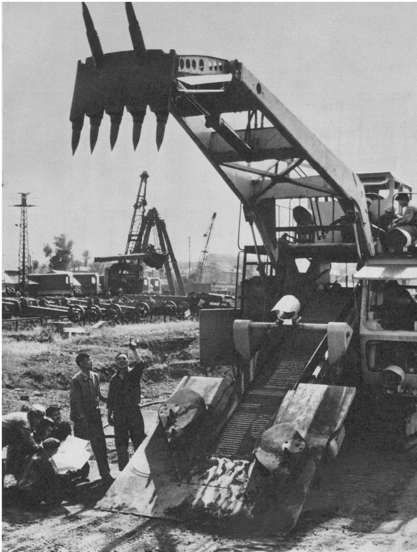
Laboristoj de la Fuŝun-a Fosmaŝina Fabriko sukcese projektis kaj fabrikis novtipan ŝarĝomaŝinon de erco, kiu povas kontinue movi aŭ laŭtavole fosi en ĉiu horo 200 kubajn metrojn da erco.
