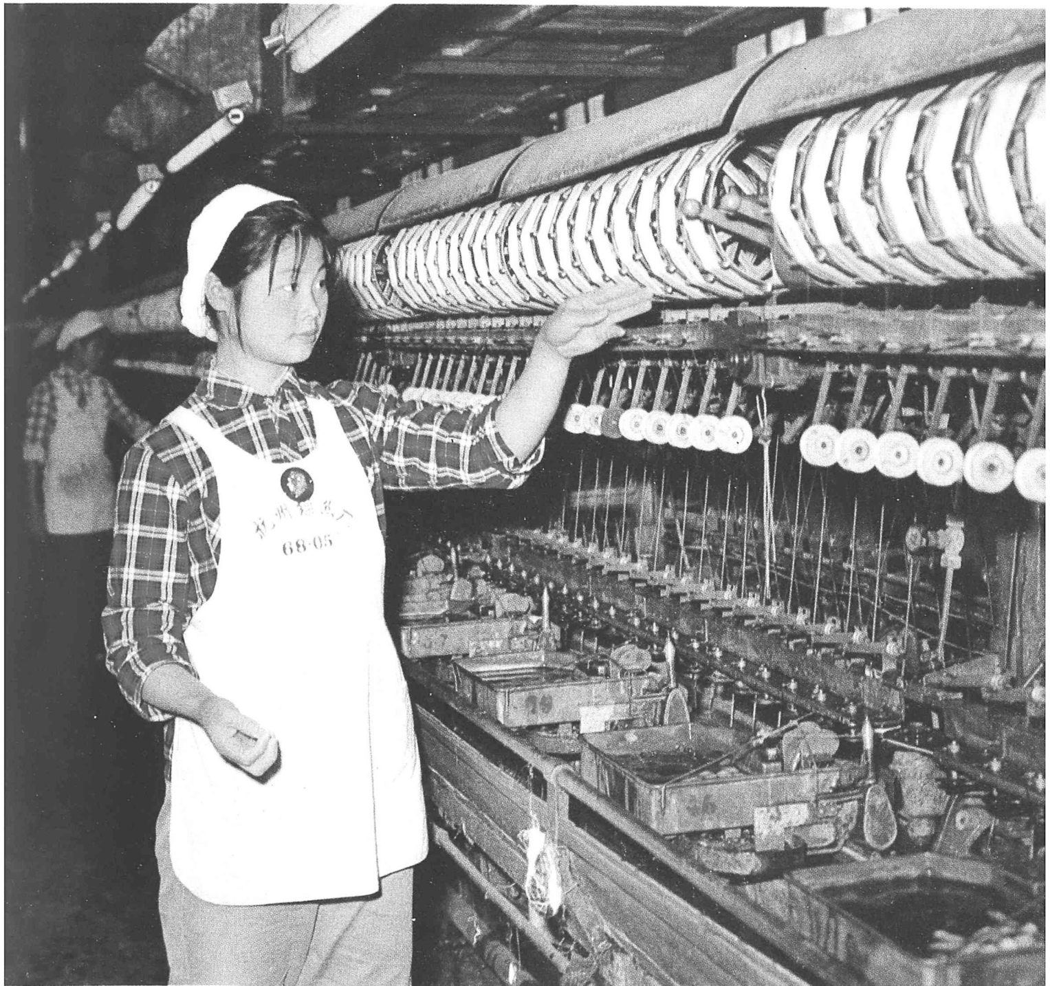
Aŭtomata kokon-bobena maŝino fabrikita de laboristoj
