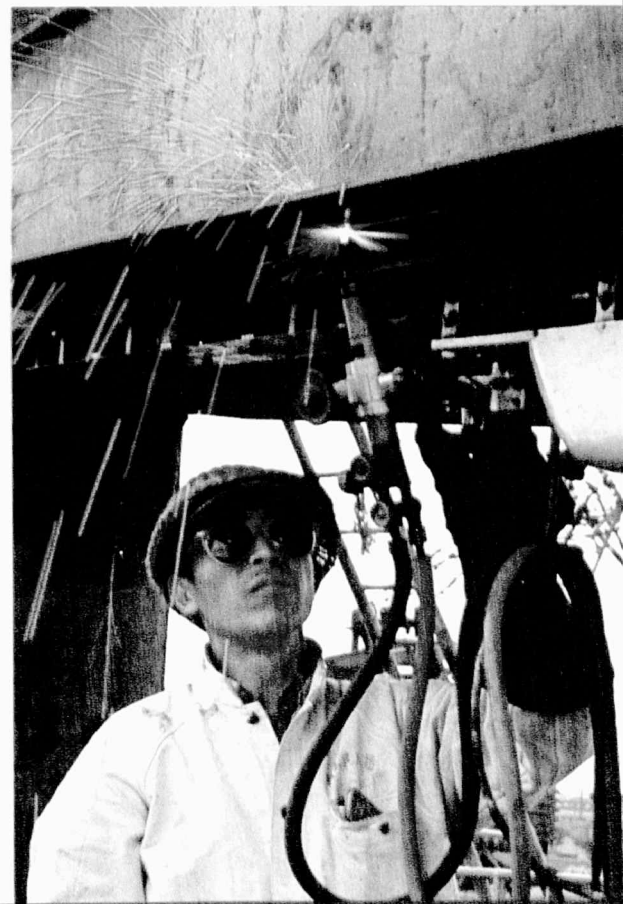
Plur-direkta tranĉmaŝino projektita kaj fabrikita de laboristoj mem estas kaj malpeza kaj facile manipulebla.
