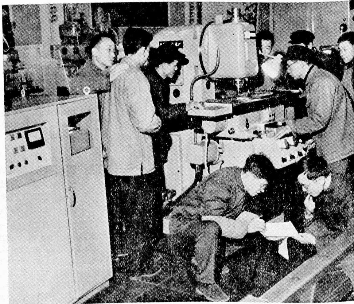
Disvolvante spiriton de komunisma kunlaboro, iuj fabrikoj en Ŝanhajo sukcese provfabrikis aŭtomatan vertikalan frezmaŝinon direktatan en procedado de elektrona komputilo cifero-tipa kun monde progresinta nivelo.
