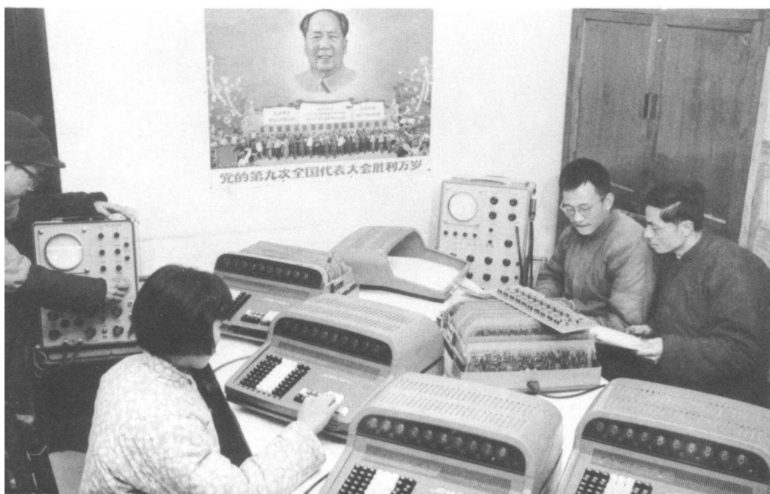
Laboristoj de la Ŝanhaja Fabriko de Komputiloj kaj Skribmaŝinoj, kiuj antaŭe tute ne posedis elektronan teknikon, nun sukcesis provfari transistoran komputilon de tabla tipo.
