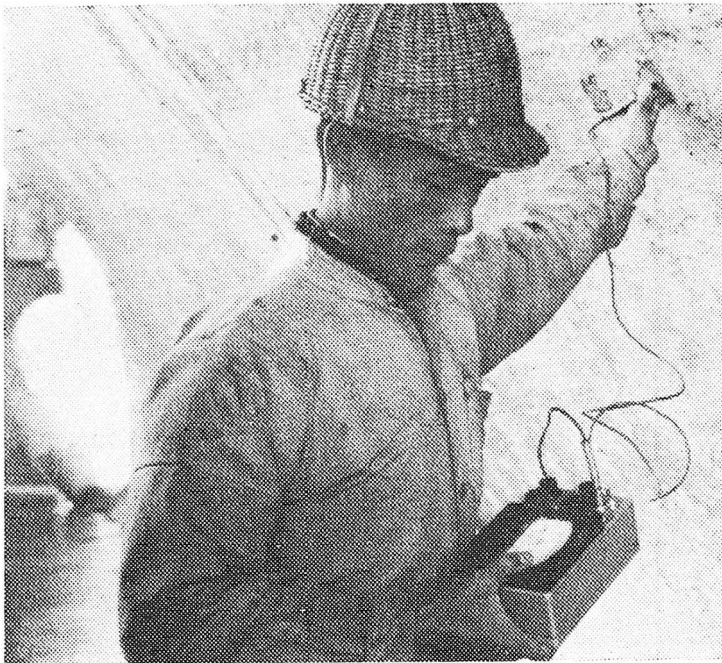
La laboristo mezuras la dikecon de la ŝipkorpa ŝtalplato per la aparato.
