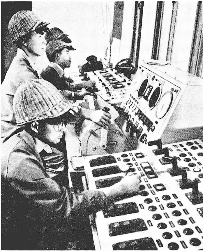
La unua laborejo de aŭtomata konvertil-forno de supra blovado per pura oksigeno en nia lando estas funkcionstruita. Jen laboristoj laboras en manipulejo (maldekstre) por (dekstre) direkti la fornon en fando de ŝtalo.
