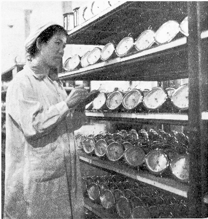
Alia amaso da vekhorloĝoj produktiĝis. Oni zorge ilin kontrolas, por ke neniu malakurata iru el la fabriko.
